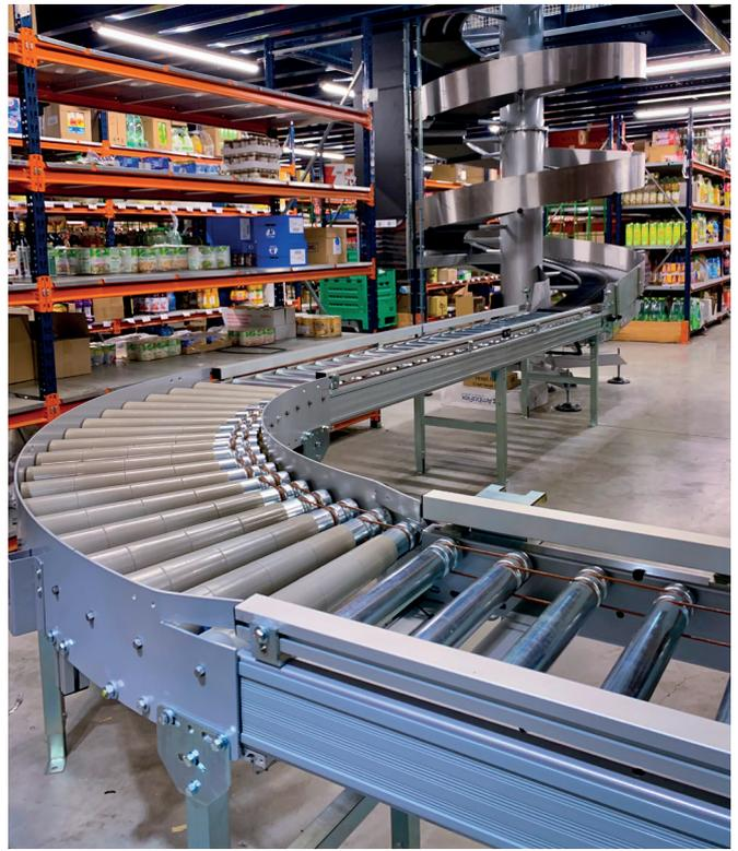
DDZZ0108: Convoyeur spirale et convoyeur rouleaux
